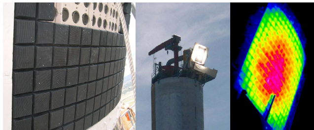
Test du récepteur volumétrique de la PSA : phase de construction (à gauche), tour en fonctionnement (au milieu), photo infrarouge (à droite)
