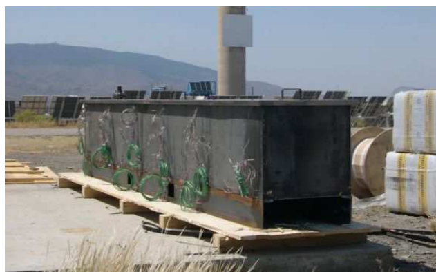
Prototype d'accumulateur à changement de phase sur la "Plataforma Solar de Almería"
